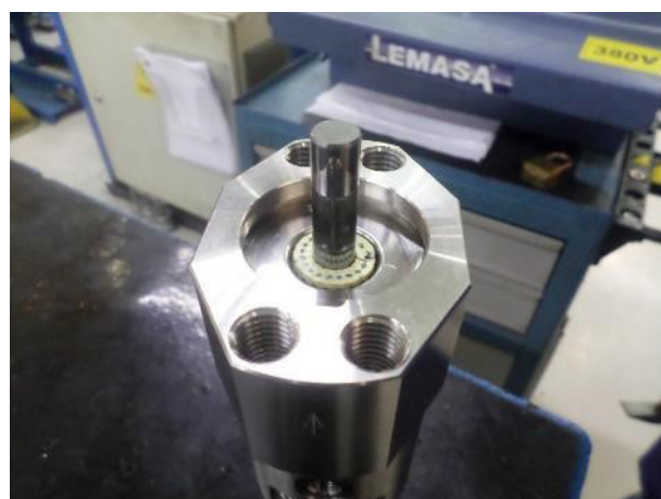
11. 插入另一个密封垫 ( 旋转180° )。压紧。
