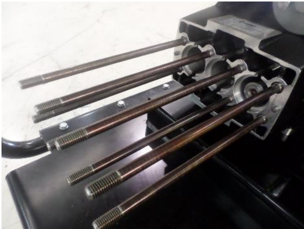
18. Atornillar los pernos en el cárter
