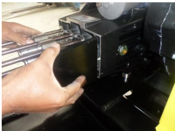
21. Introducir el separador utilizando los pernos como guías
