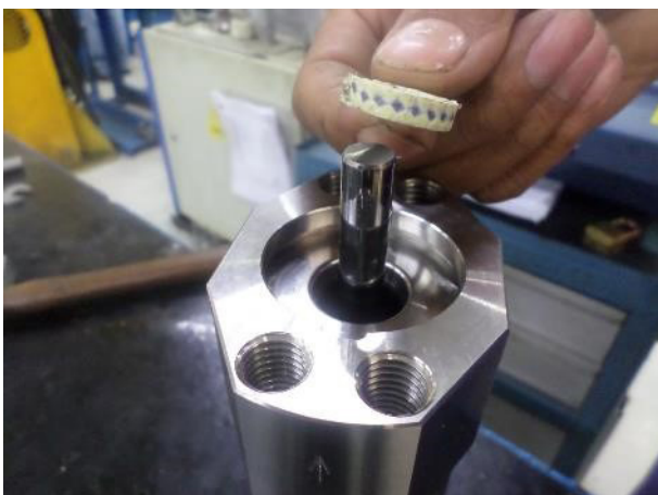
10. Die Dichtung (15) einsetzen und mit Hilfe eines Hammers und eines Kunststoffrohrs zusammendrücken.
