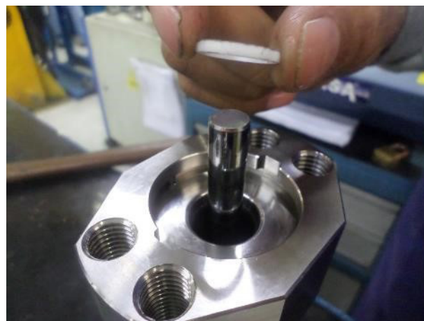
7. Inserisci la guarnizione posteriore
