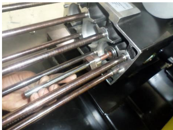
19. Vissez les pistons dans les guides appropriés
