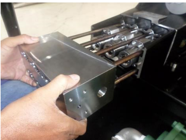
22. Den Zylinderkopf einsetzen, indem die Stifte als Führung verwendet werden
