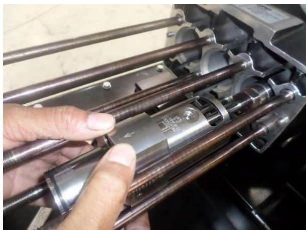
20. Insérez les supports dans les pistons
