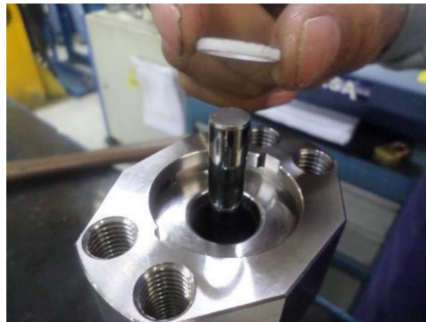
7. Introducir la junta trasera
