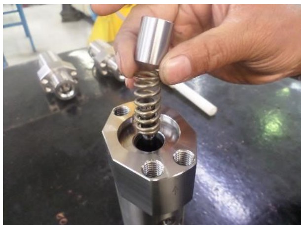
14. Introducir el Muelle (6) y el Soporte del Muelle (5)
