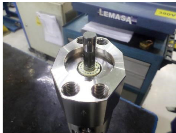
11. Вставьте другую прокладку (повернутую на 180°). Прижмите.
