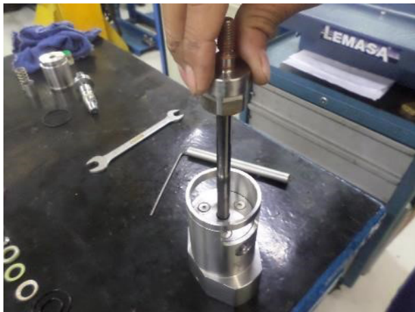
5. Insérez le piston dans le support
