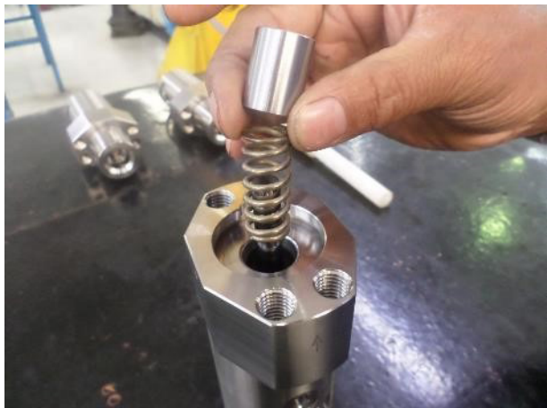
14. Вставьте пружину (6) и опору гайки (5)
