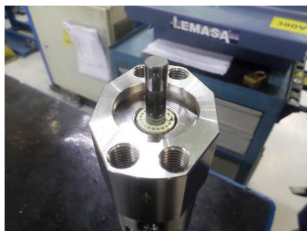
11. Inserire l'altra guarnizione (ruotata di 180°). Comprimere.
