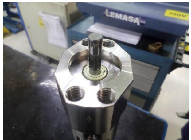
11. Die andere Dichtung (um 180° gedreht) einsetzen. Zusammendrücken.
