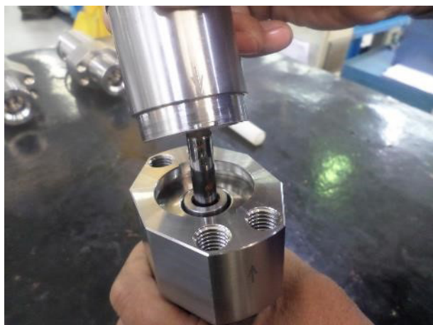
15. Insérez le support avant
