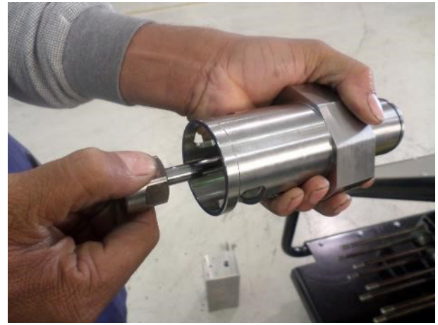
17. Den Kolben von der Halterung entfernen
