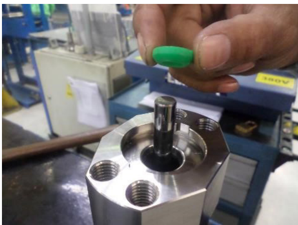
8. Introducir la junta UHP (14)
