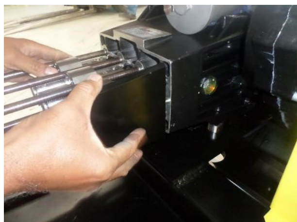
21. Insira o espaçador utilizando os pinos como guias
