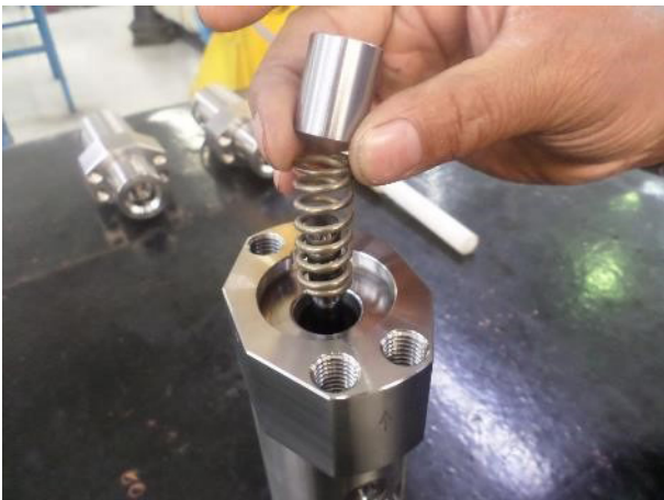
14. Die Feder (6) und die Federhalterung (5) einsetzen
