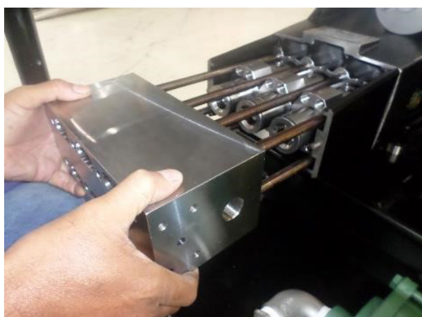
22. Introducir el cabezal utilizando los pernos como guía
