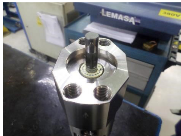
11. Introducir la otra junta (girada 180°). Comprimir.
