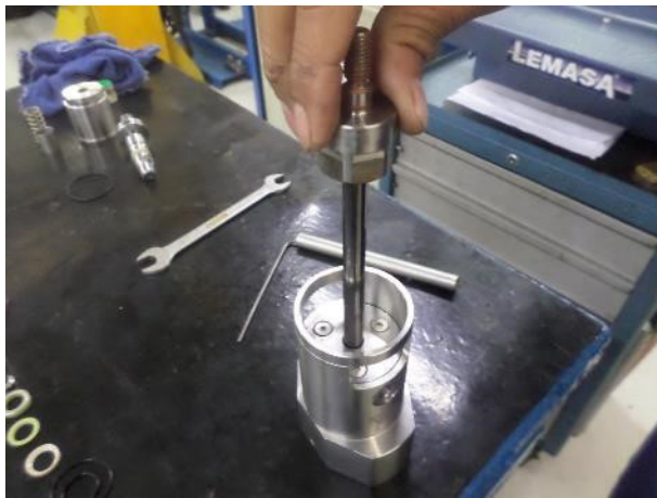
5. Den Kolben in die Halterung einsetzen
