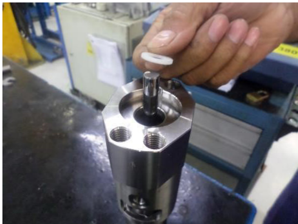
12. Вставьте заднее кольцо (16) и прижмите его с помощью молотка и пластиковой трубки
