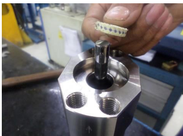
10. Inserire la guarnizione (15) e comprimere con martello e tubo di plastica.
