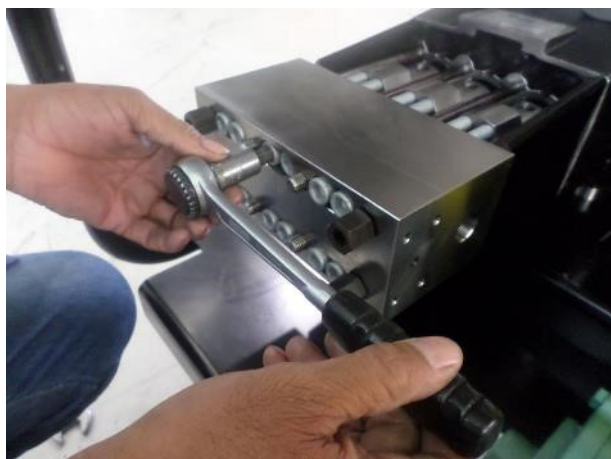
26. Serrage des vis M24x160 en mode croisé en 3 phases : 50 / 100 / 140 Nm..
