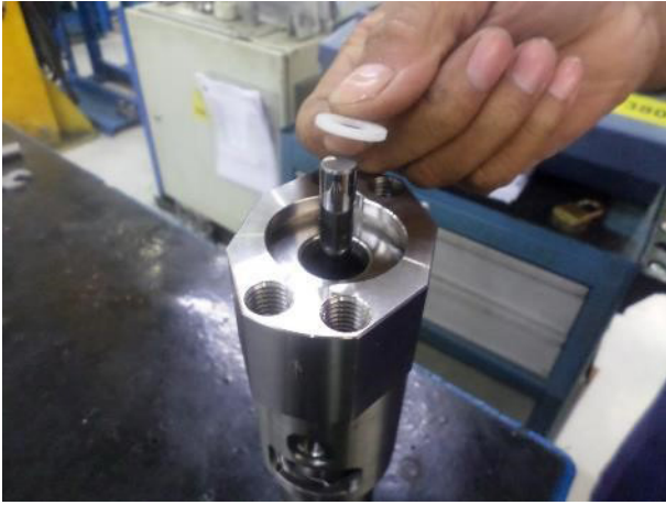
12. Den hinteren Ring (16) einsetzen und mit Hilfe eines Hammers und eines Kunststoffrohrs zusammendrücken
