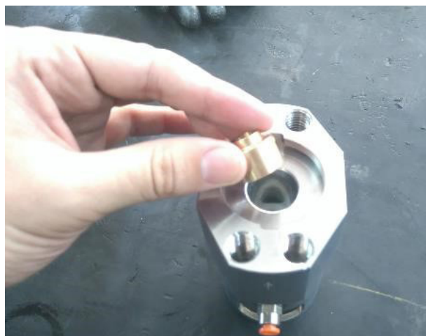
13. Insérez la bague (17)
