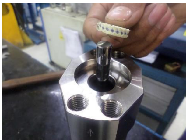
10. 插入密封垫 ( 15 )，用锤子和塑料管压紧。
