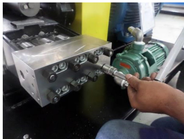
25. Sujeción transversal de 3 fases: 30 Nm / 60 Nm / 100 Nm.
