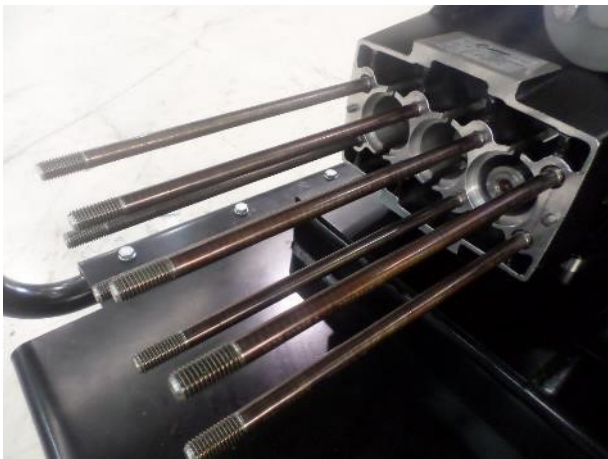
18. Die Schrauben am Gehäuse festziehen
