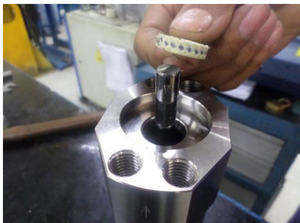
10. Вставьте прокладку (15) и прижмите ее с помощью молотка и пластиковой трубки.
