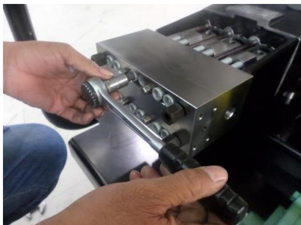
26. Sujeción tornillos M24x160 transversal de 3 pasos: 50 / 100 / 140 Nm.
