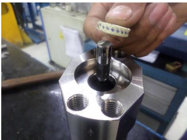
10. Introducir la junta (15) y comprimir con un martillo y un tubo de plástico.
