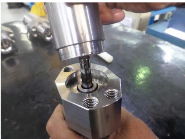
15. Die vordere Halterung einsetzen
