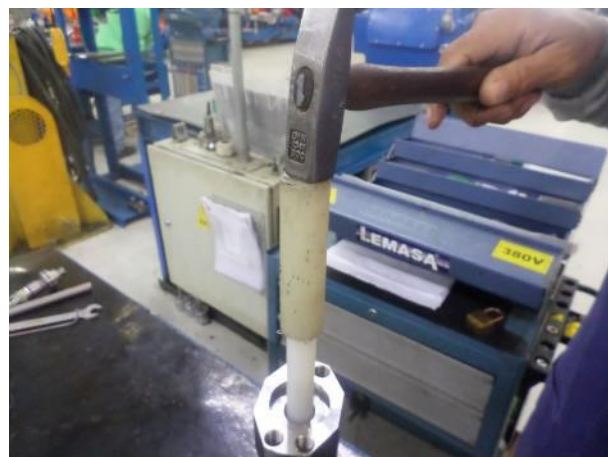
9. Comprimez à l'aide d'un marteau et d'un tube en plastique
