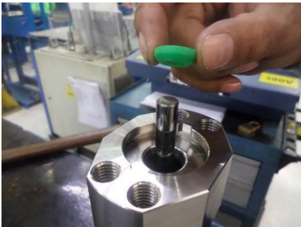
8. Die UHP-Dichtung (14) einsetzen
