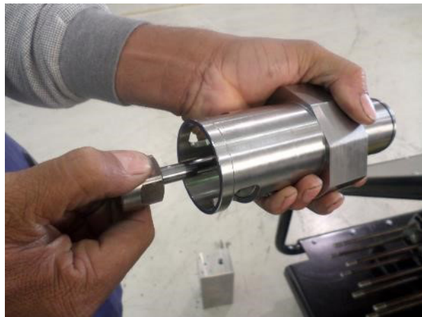
17. Retirez le piston du support
