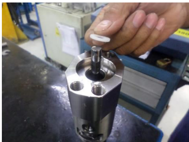
12. Introducir el anillo trasero (16). comprimir con un martillo y un tubo de plástico
