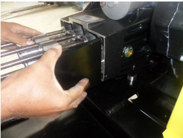
21. Das Distanzstück einsetzen, indem die Stifte als Führung verwendet werden
