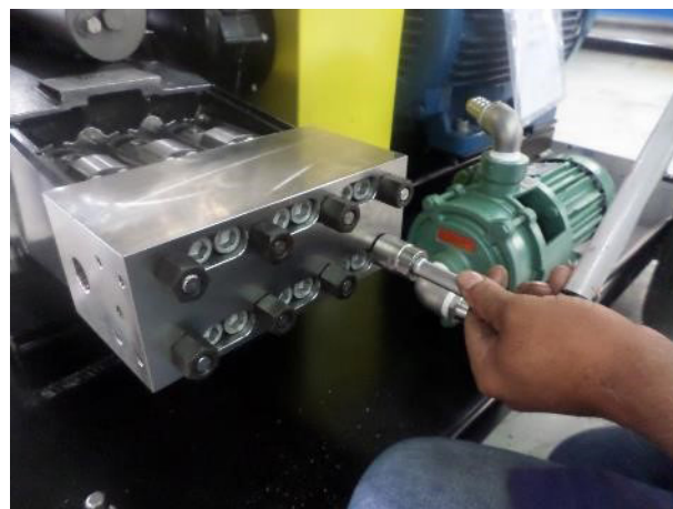
25. 横向分3步拧紧：30 Nm / 60 Nm / 100 Nm。
