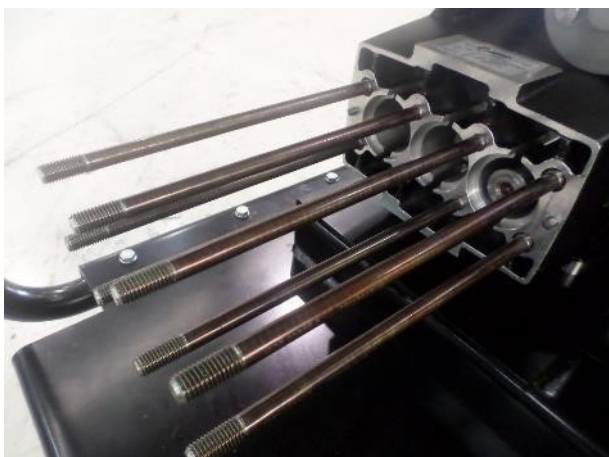
18. Vissez les boulons dans le carter
