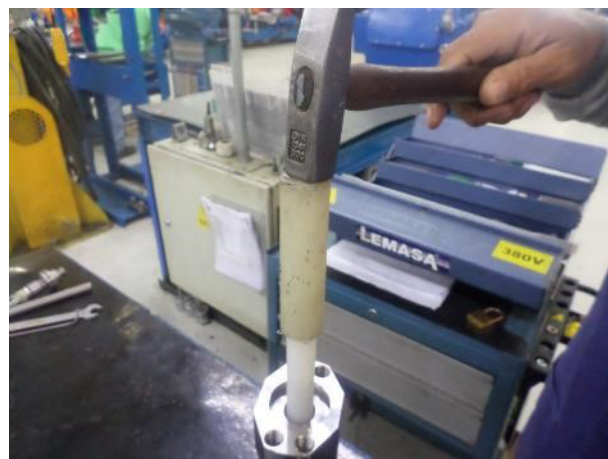
9. Comprimir usando un martillo y un tubo de plástico
