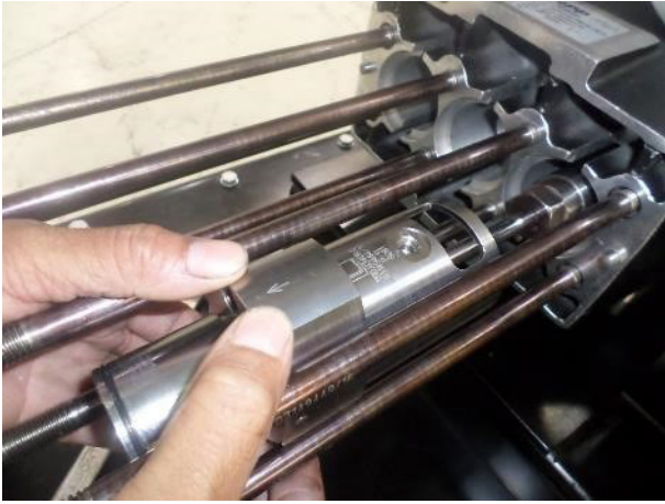
20. Die Halterungen in den Kolben einsetzen
