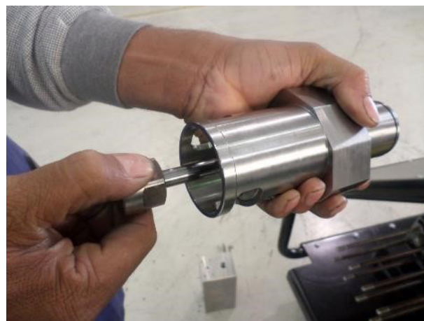
17. Выньте поршень из опоры
