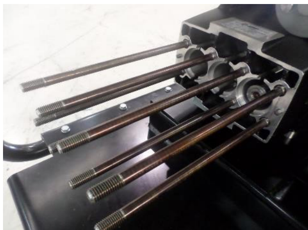
18. Aperte os parafusos no cárter
