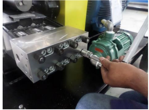
25. Kreuzweise in 3 Phasen anziehen: 30 Nm / 60 Nm / 100 Nm.
