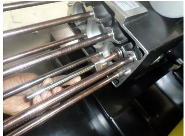
19. Avvitare i pistoni nella guida pistoni
