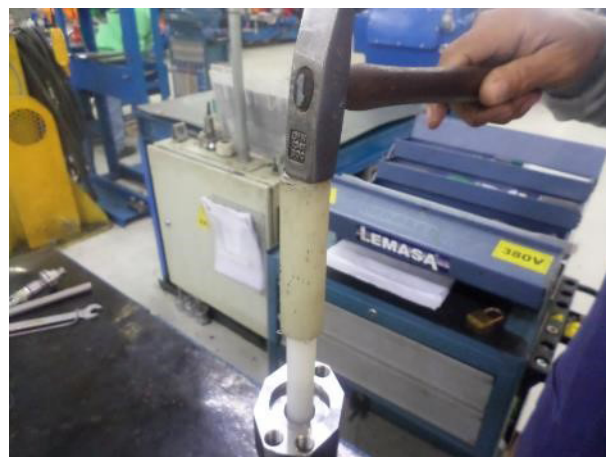
9. Прижмите с помощью молотка и пластиковой трубки
