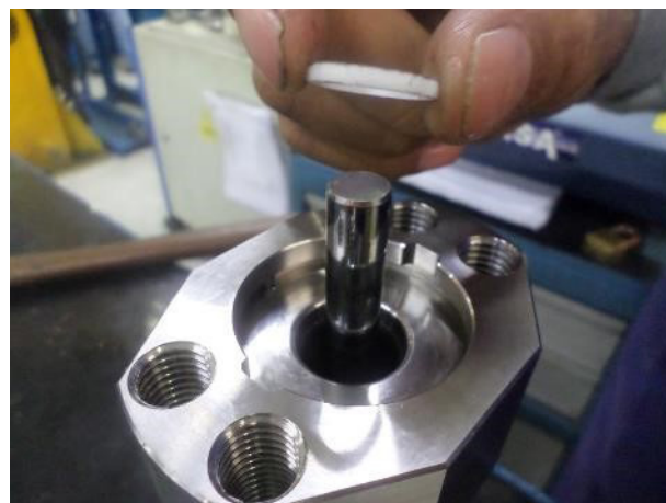
7. Insérez le joint arrière
