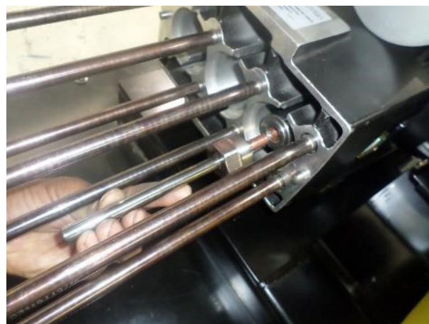
19. Вверните поршни в направляющую поршней
