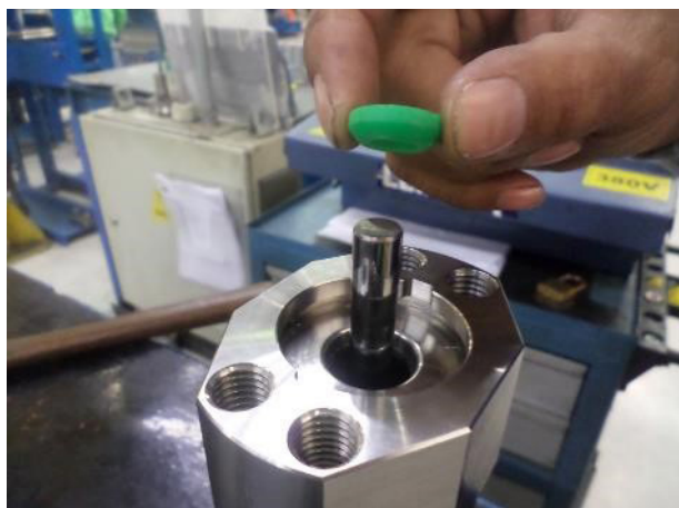
8. Insérez le joint UHP (14)
