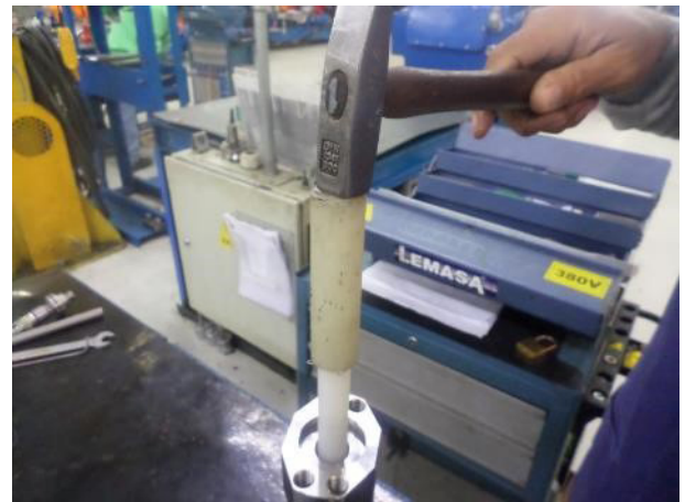
9. Mit Hilfe eines Hammers und eines Kunststoffrohrs zusammendrücken
