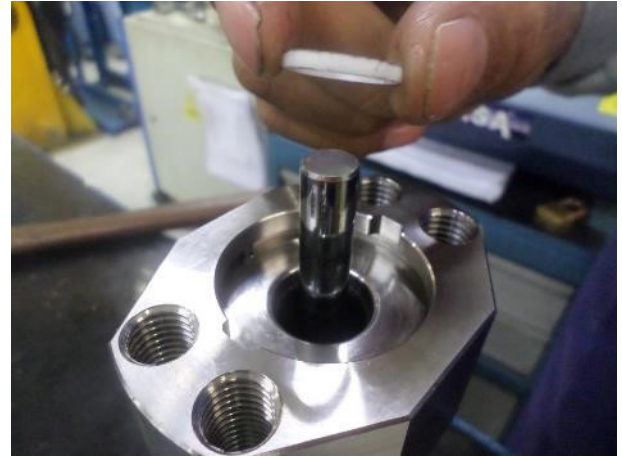
7. Setzen Sie die hintere Dichtung ein
