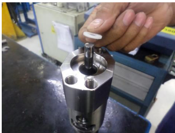
12. 插入后环 ( 16 ) , 用锤子和塑料管压紧
