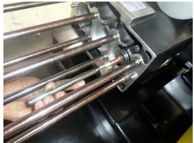
19. Die Kolben an der Kolbenführung fest-schrauben
