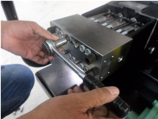
26. Serraggio viti M24x160 in modo incrociato di 3 passi: 50 / 100 / 140Nm.
