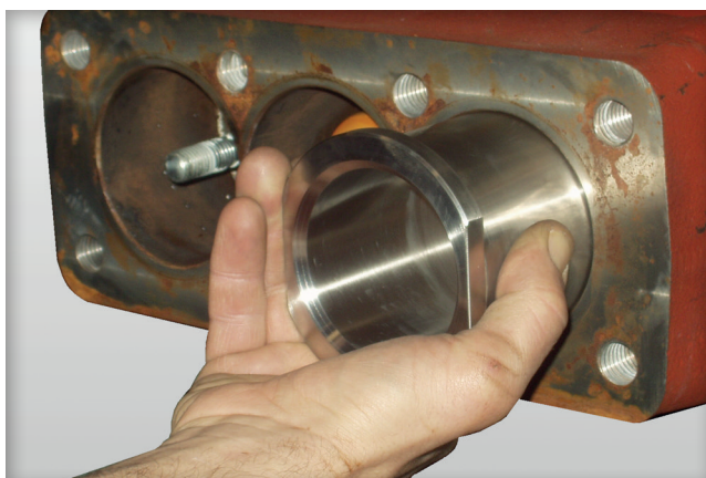
03 Fare attenzione nello smontaggio dei supporti (pos. 24) a non danneggiare le sedi di tenuta.
