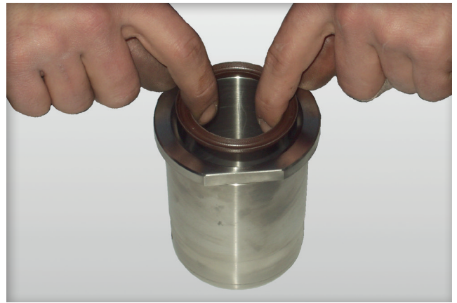
04 Positionner le groupe support des garnitures sur un plan propre et dégager les garnitures (pos. 3).
