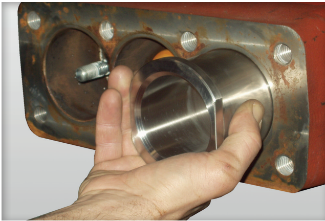
03 Lors du démontage des supports (pos. 24) veiller à ne pas endommager les sièges de garniture.
