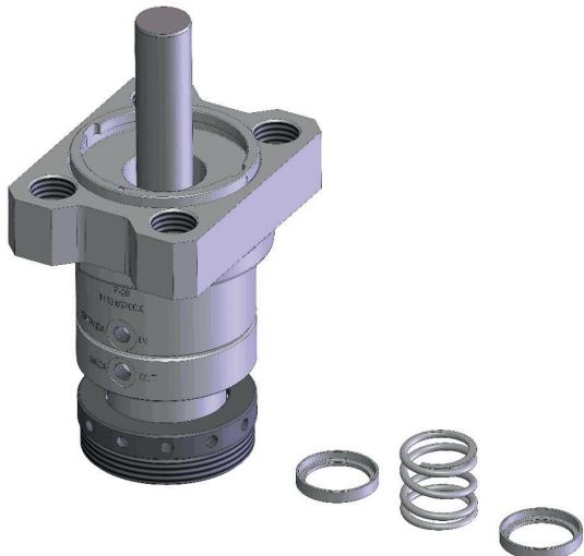
ARRANGE THE COMPONENTS FOR PACKING SPRING ASSEMBLY.
