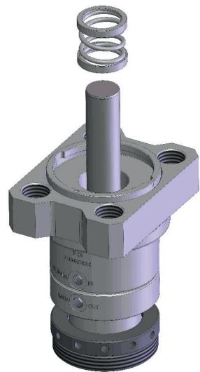
INSERT THE PACKING SPRING ALREADY ASSEMBLED.
